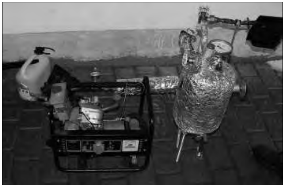
Bild 8: Notstromaggregat mit GEET-Vorrichtung.
