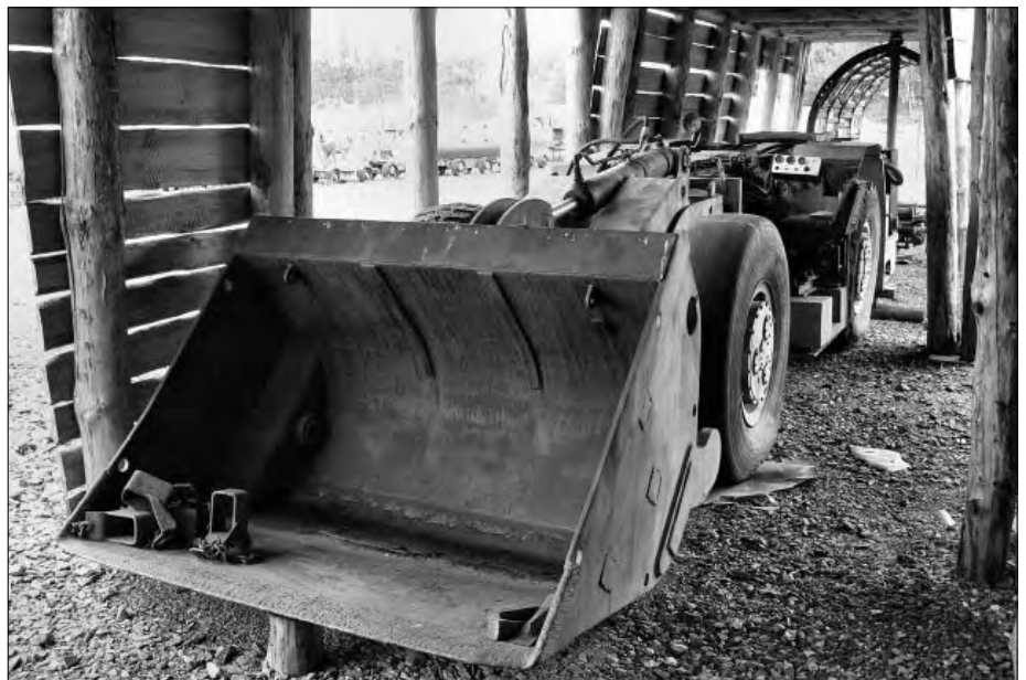
Bild 8: Schaufelbagger für Erz.
