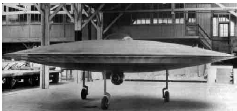
Die Flugscheibe Couzinets mit drehendem Außenrotor
