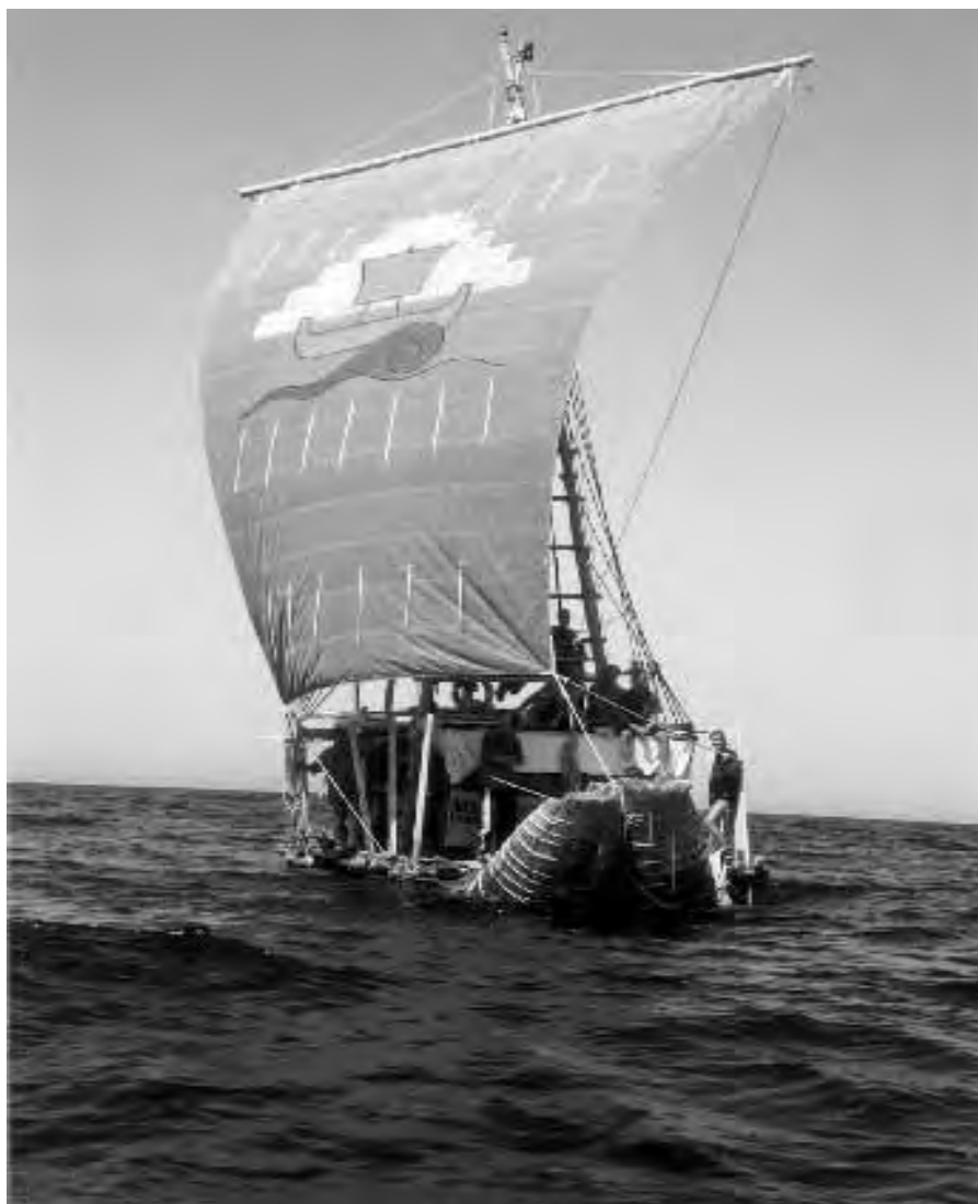
Abb. 17: Das nach steinzeitlichen Felsbildern aufgetakelte Schilfboot unter vollen Segeln. Mit ihrer speziellen Takelung konnte sie bei günstigem Wetter bis 85° gegen den Wind segeln.
