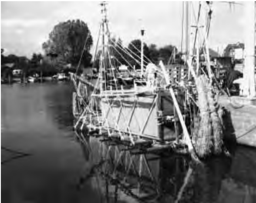
Abb. 4: Das Schilfboot DILMUN I wurde aus Gemeinem Schilfrohr gebaut, das fast neun Wochen auf der Ostsee schwamm, ohne dass es seinen Auftrieb verlor.
