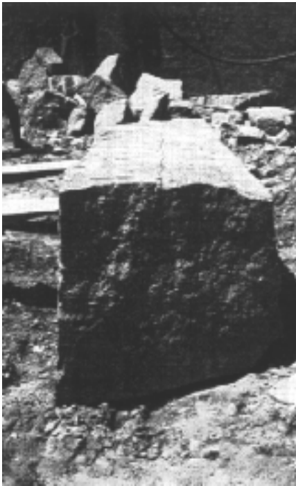
Abb. 3: Deutlich erkennt man, wie der Granit auf der Linie bricht, wo die Keile hineingetrieben wurden. (Foto: © Löhner)
