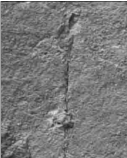
Bild 5: In der Vergrößerung zeigt sich, dass die Trennfuge doch nicht so eindeutig ist. Kristalle scheinen von einem Block in den anderen überzugehen.
