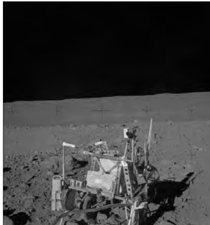
Der Karren, den die Astronauten von Apollo 14 mitführten. Man beachte die dünnen Reifen (NASA-Foto AS14-64-9121)
