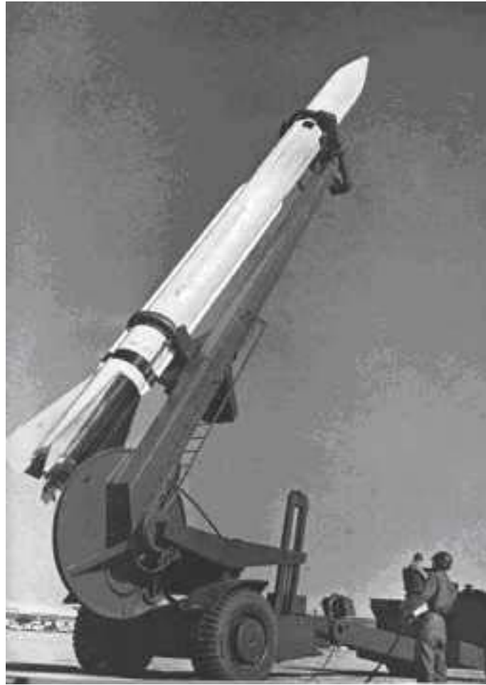
Eine amerikanische Corporal-Rakete mit einem Aufricht-Fahrzeug (Helmut Gröttrup: „Über Raketen“, Berlin 1959)
