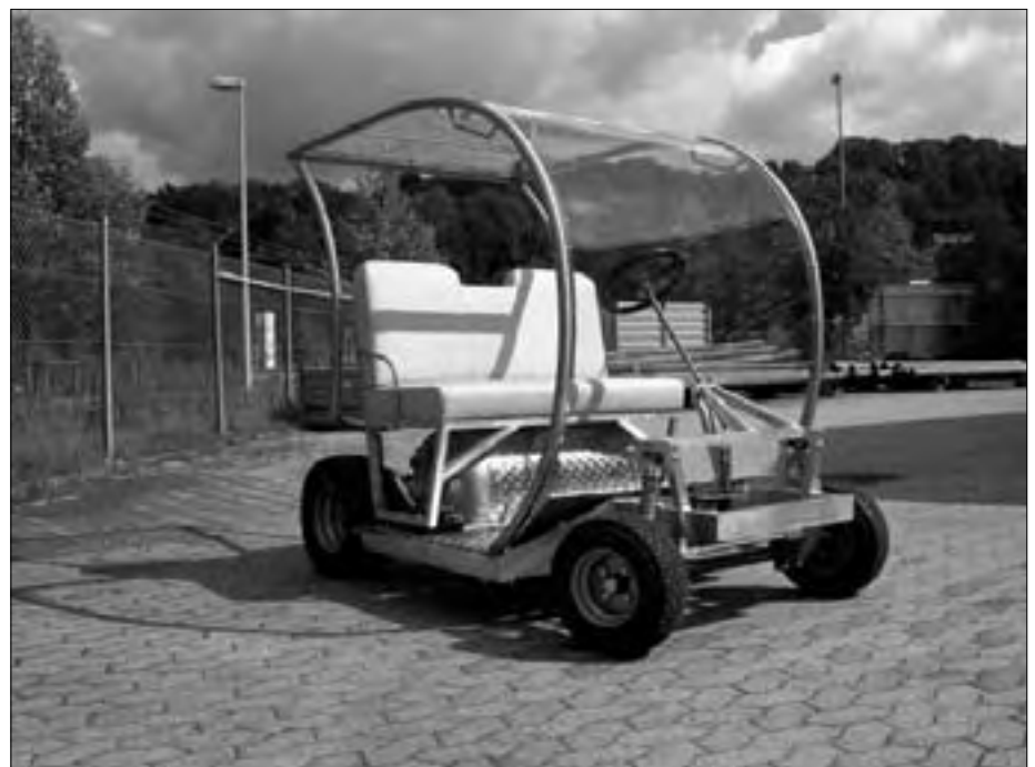
Abb. 7: Golf-Caddy mit Stickstoffantrieb
