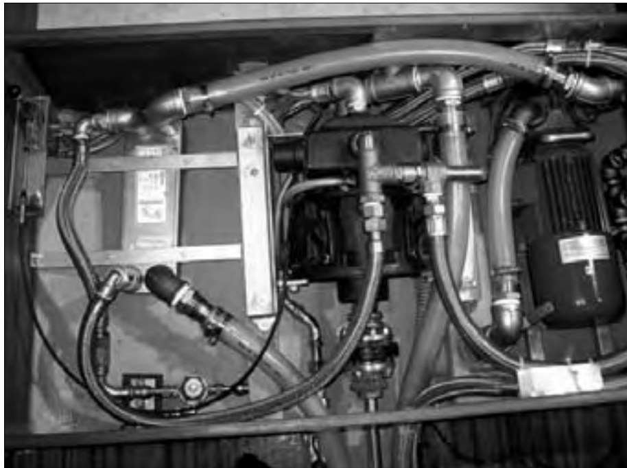
Abb. 3: Stickstoffantrieb für ein Motorboot.
