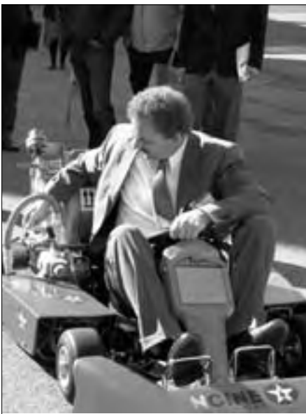
Abb. 6: Gokart mit Stickstoffantrieb
