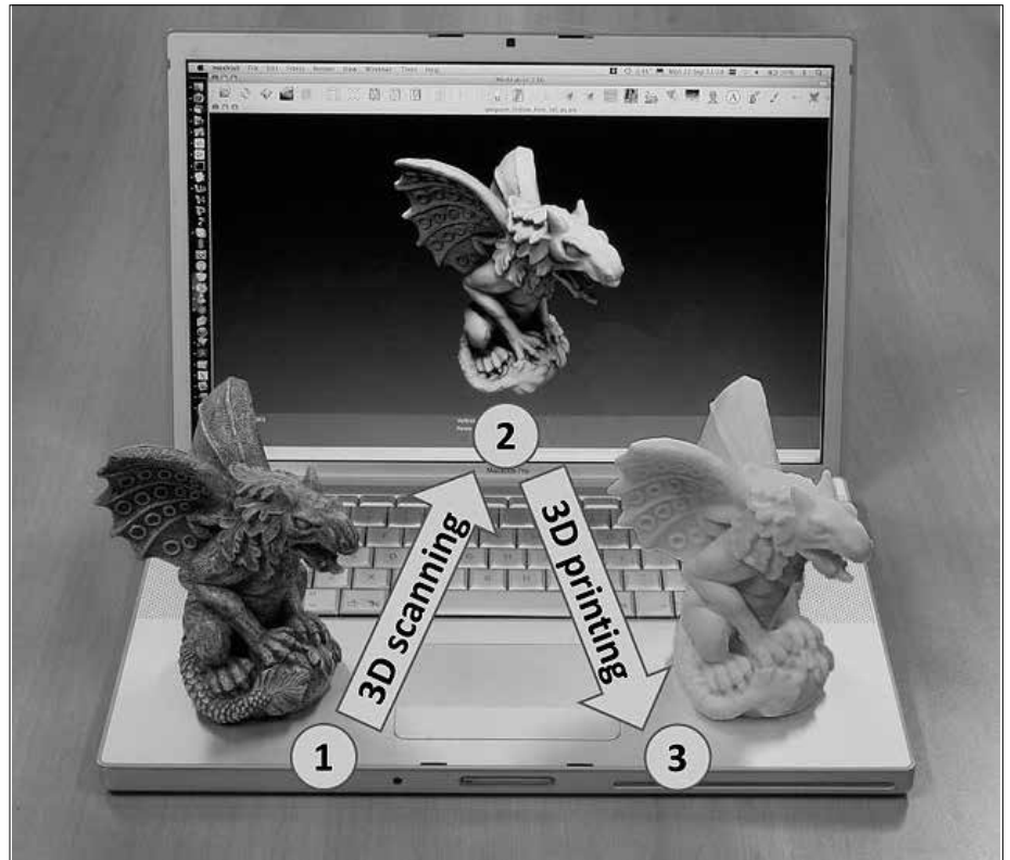
Funktionsweise eines 3D-Druckers: Ein kleines Gargoyle-Modell wurde zunächst eingescannt und dann mit einem 3D-Drucker „ausgedruckt“ (Wikipedia).
