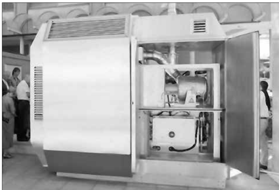
Bild 2: Das Methanol-Minikraftwerk „Econimo“ liefert Strom (25 kW) und Wärme zum Heizen (70 kW) oder kaltes Wasser zum Kühlen (40 kW).
