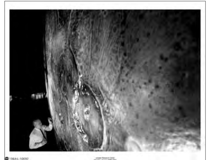
So sehen die späteren Mondmodelle vorher aus. Rechts erkennt man den Aufhängemechanismus. Auf den anderen Bildern die Künstler bei der Herstellung der Oberfläche, anhand von Mondfotos.
