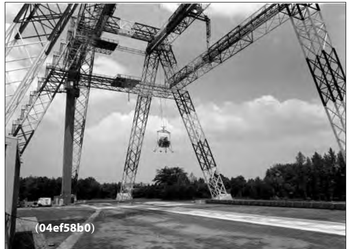
Der große Traversenkran, mit dem die Landung von Landefähren auf dem Mond simuliert wurde.
