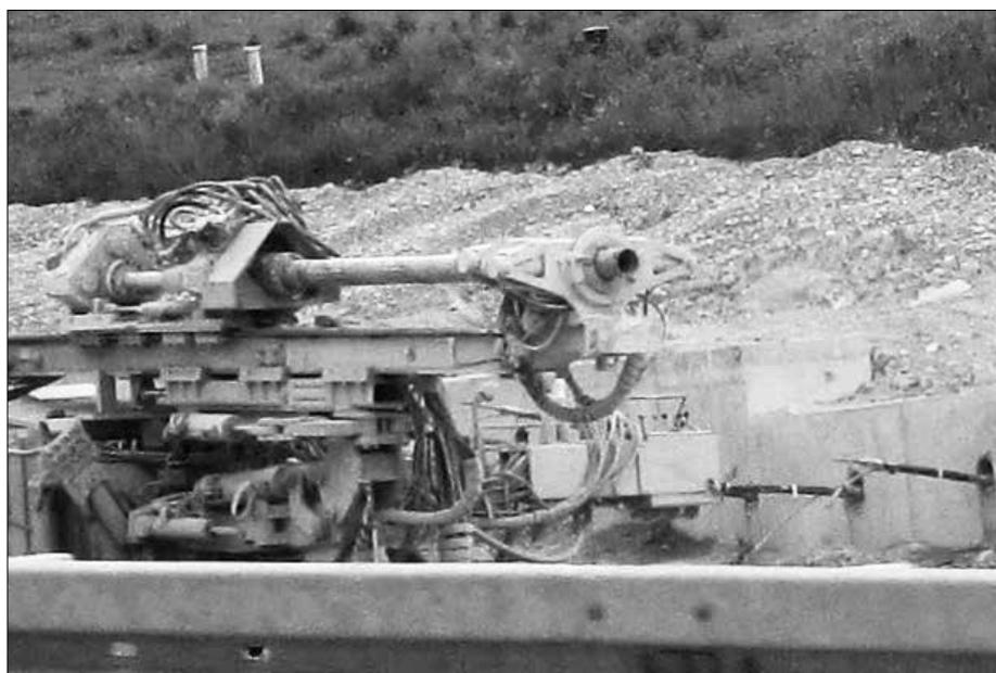
Zum Vergleich: Solche Hochleistungsmaschinen benötigt man, um heute rund zwanzig Zentimeter durchmessende Kernbohrungen in Betonplatten bohren zu können (rechts erkennbar).
