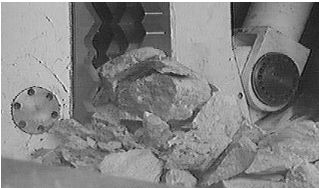
Die Spezialzerkleinerungsanlage für größere Felsbrocken
