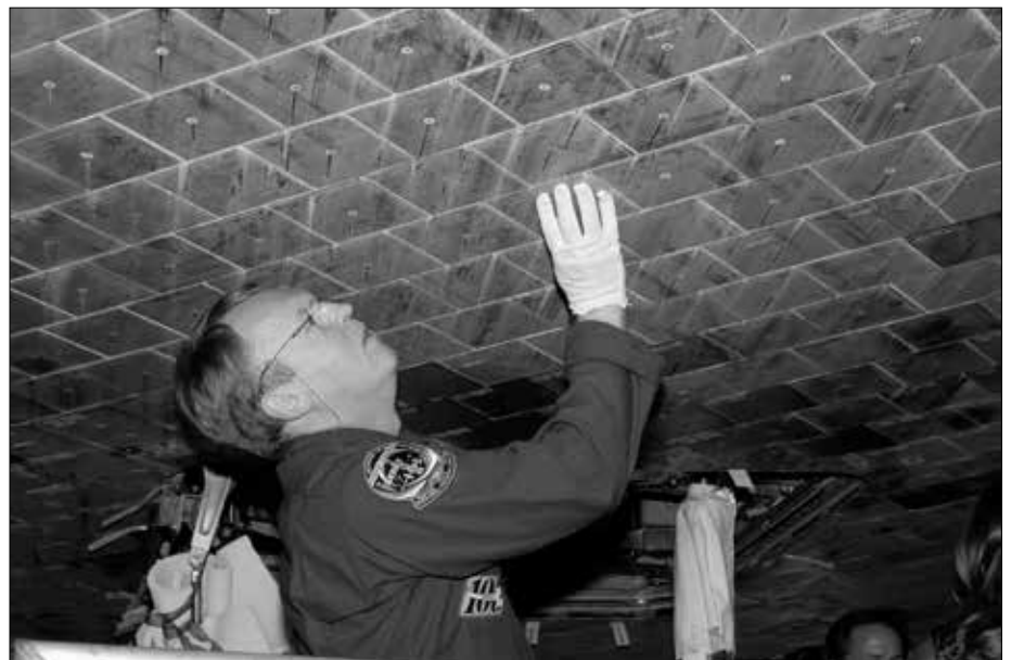
Hitzeschild-Kacheln an der Unterseite eines Space-Shuttles (NASA).
