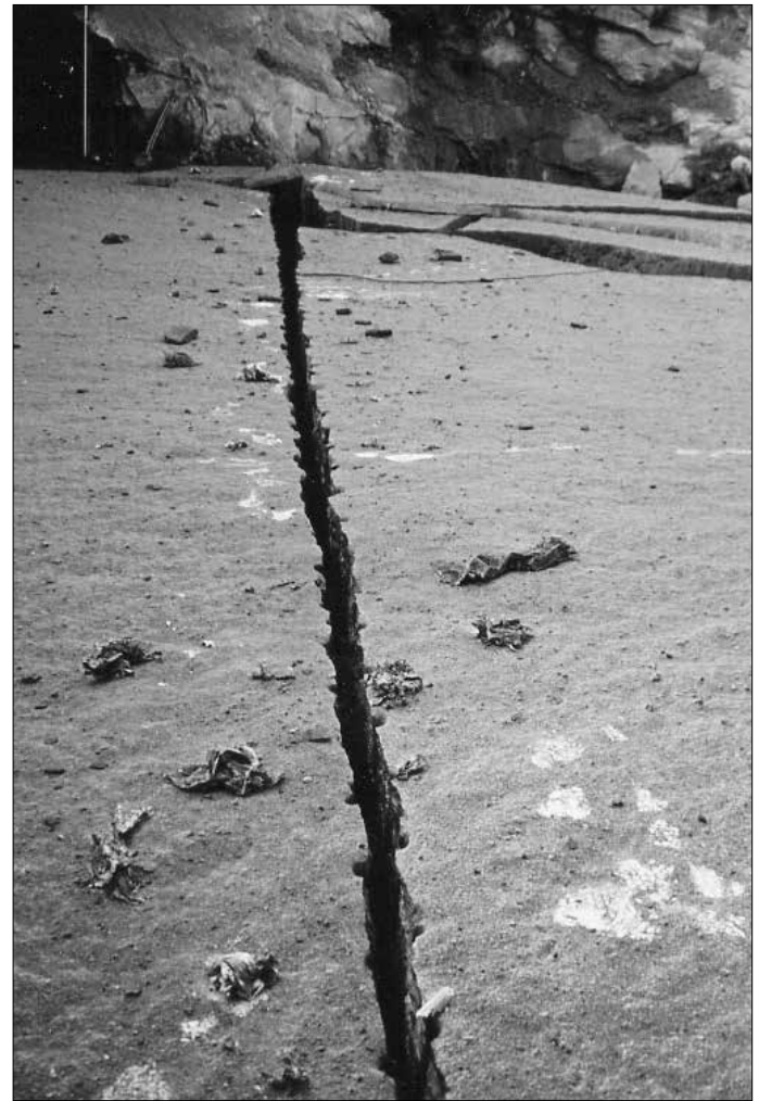
Abb. 3 (links): Deutlich erkennt man, wie der Granit auf der Linie bricht, wo die Keile hineingetrieben wurden. Abb. 4 (rechts): Der gebrochene Granitblock. (Alle Fotos: Franz Löhner)
