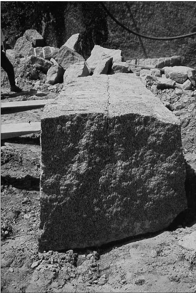
Abb. 3 (links): Deutlich erkennt man, wie der Granit auf der Linie bricht, wo die Keile hineingetrieben wurden. Abb. 4 (rechts): Der gebrochene Granitblock. (Alle Fotos: Franz Löhner)
