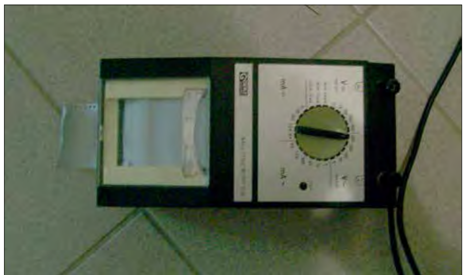
Abb. 9: Stripchart-Recorder = Streifen-schreiber: Er enthält ein mit Wechselstrom betriebenes Uhrwerk, das die Trommel mit dem Papier für die Aufzeichnung bewegt.
